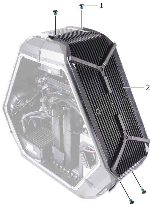
Figura 72. Rimozione del pannello della base
